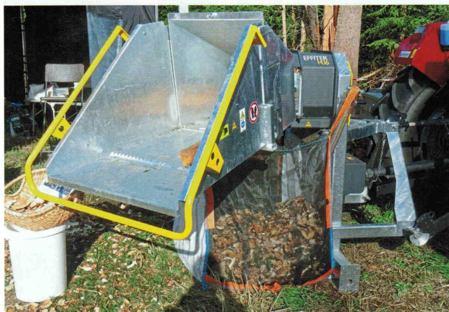
Abb. 1: Schneckenhacker Effiter 14,16 von Alvatec mit angehängtem Big Bag
