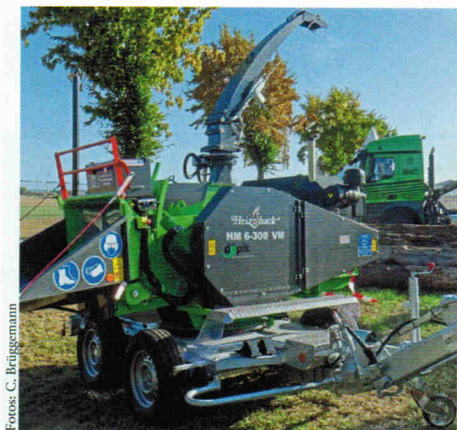
Abb. 2: Trommelhacker Heizohack HM 6-300 VM von Heizomat
